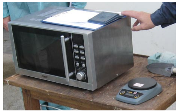
Fot. 3. Sprzęt do pomiaru suchej masy zielonki lub TMR
