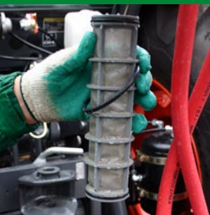
Demontaż wkładów filtrów ssawnego i ciśnieniowego
