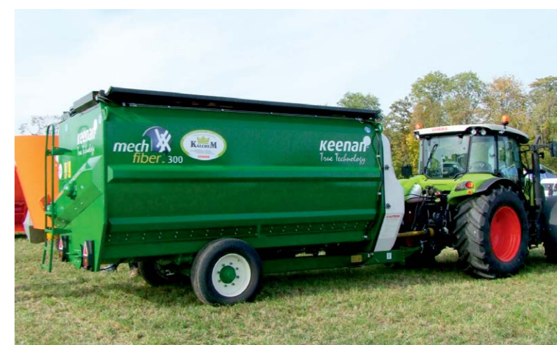
Keenan Mech Fiber 300 Baleblend 10 m 3 , poziomy system mieszający, łopatoowo-przerzutowy 2,60 x 2,50 m, Kalchem Sp. z o.o., Wielki Głębczek
