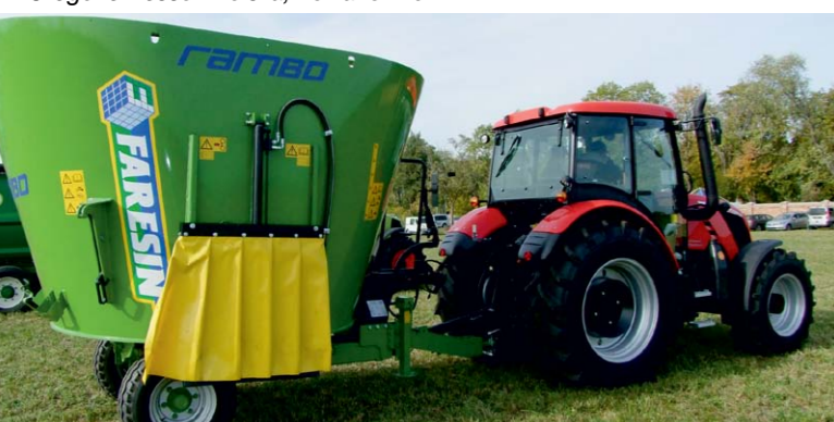
Faresin Rambo 1100 2,68 x 2,35 m, ślimak pionowy Faresin Industries SPA, Czernikowo
