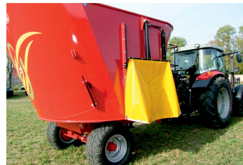
Wóz paszowy WP10 10 m 3 , jednoślismakowy pionowy 2,60 x 2,60 m METALTECH Sp. z o.o., Mirostówiec
