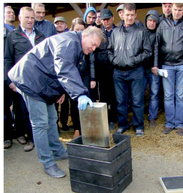
Ocena homogenności TMR-u na specjalnych sitach
