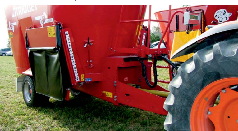
Trioliet Solmix 21200 ZK 12 m 3 , dwa ślimaki pionowe 2,50 x 2,30 m Agromix, Rojęczyn
