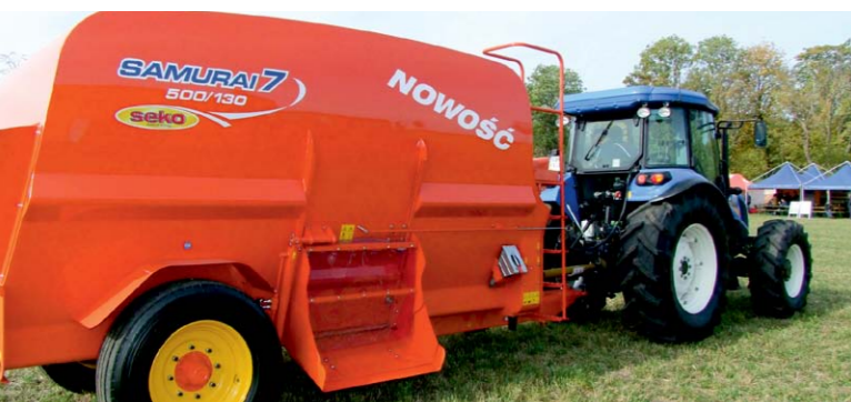
Seko Samuraj 7 500/130, 13 m 3 , poziomy system mieszania 2,52 x 2,10 m PHU Perkoz Sp. z o.o., Brodnica
