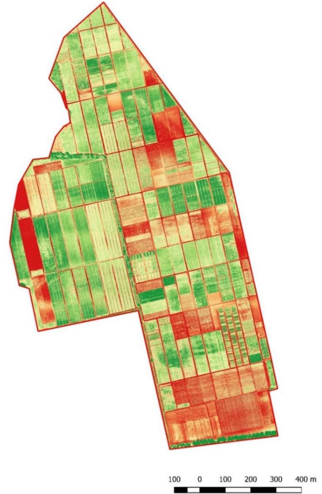
Rysunek 2. Obraz terenu PSD Winna Góra pozyskanego z pozycji dronowej (400 m.n.p.g.), przekształconego na wskaźnik NDVI (ang. Normalized Difference Vegetation Index). Wielkość piksela dla tej sceny wynosi 10x10 centymetra
