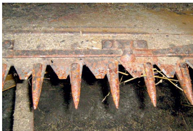
Skorodowany zespół tnący na skutek niewymontowania listwy nożowej i braku zabezpieczenia antykorozyjnego
