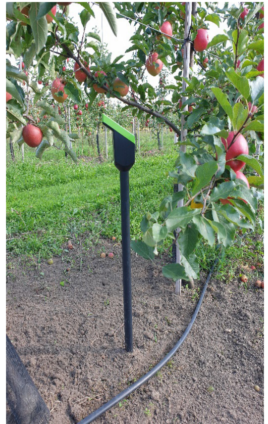
Fot. 1. Bezprzewodowy czujnik pomiaru wilgotności, temperatury i zasolenia gleby
