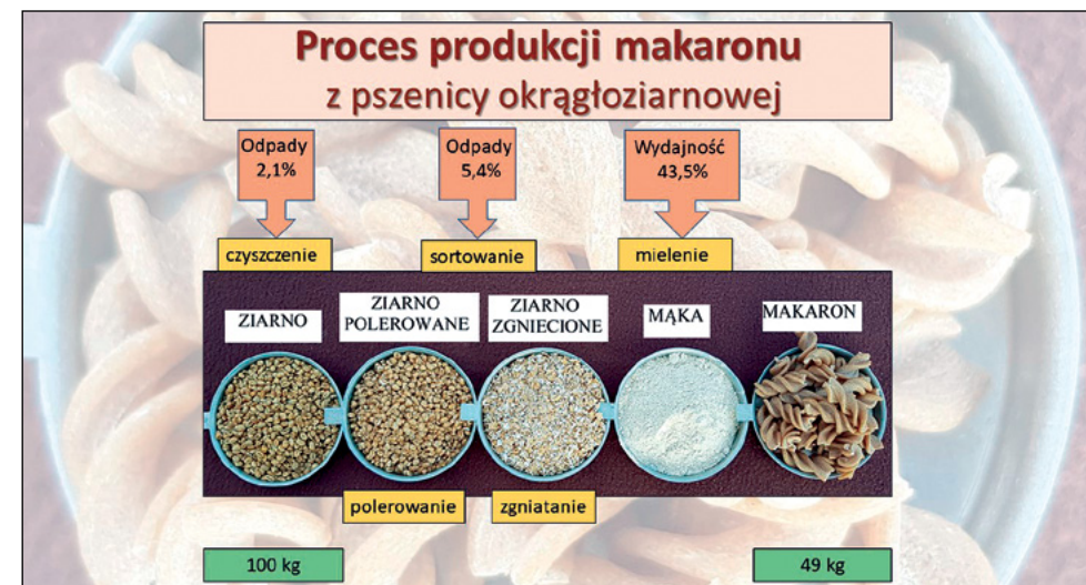
Rys. 60. Proces produkcji makaronu z ziarna pszenicy okrągłoziałowej
