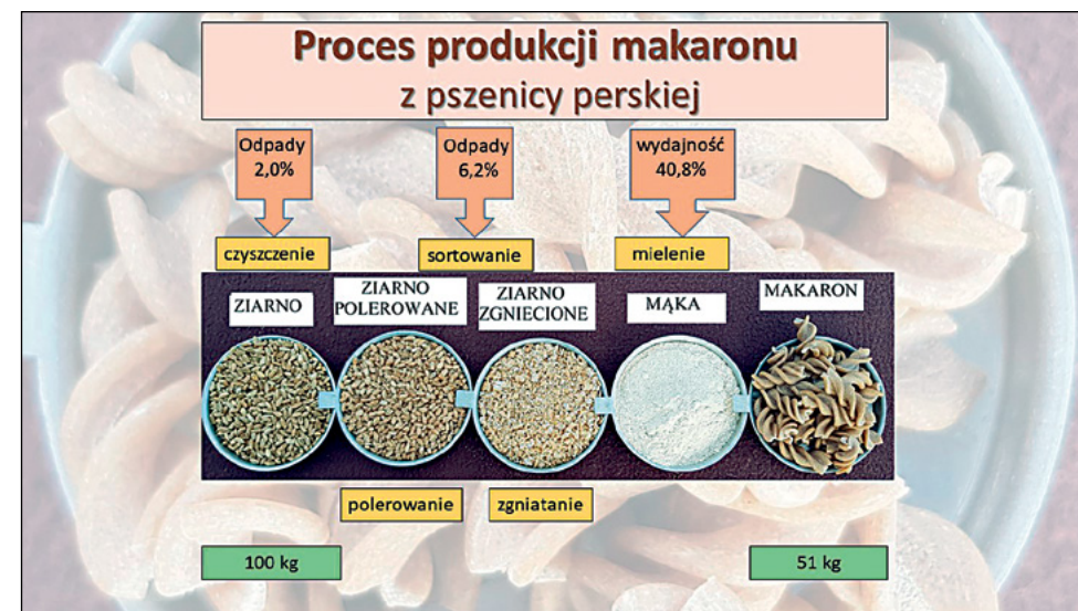
Rys. 62. Proces produkcji makaronu z ziarna pszenicy perskiej
