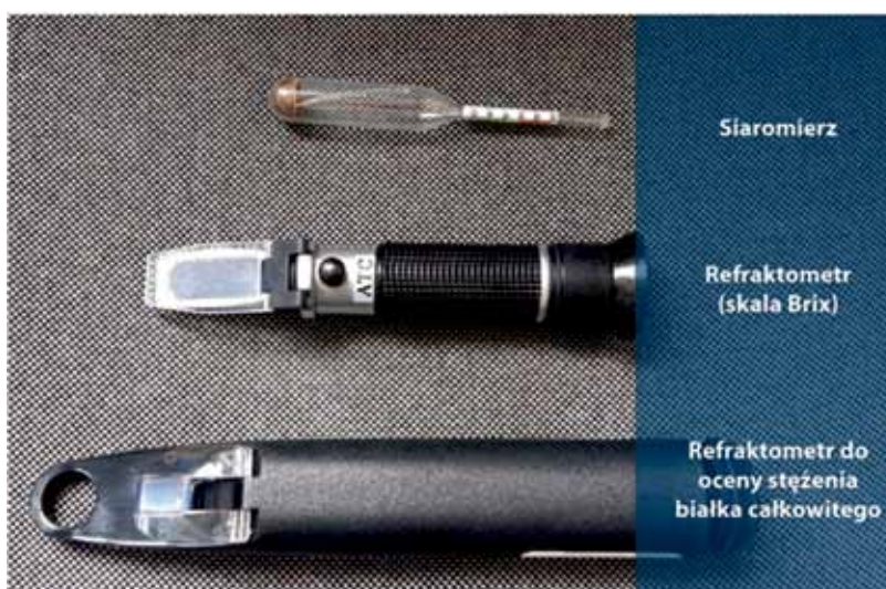
Urządzenie przydatne w terenowej ocenie jakości siary lub zawartości białka całkowitego w surowicy krwi cieląt
