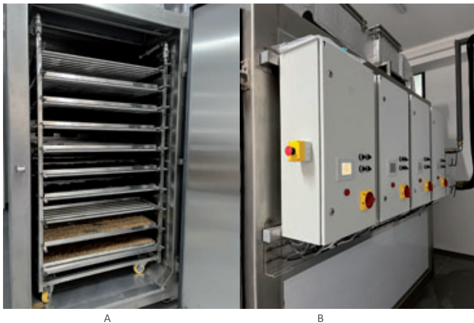
Fot. 24. Młóto umieszczone w komorze urządzenia do dehydracji (A) oraz panel sterujący urządzeniem (B)
