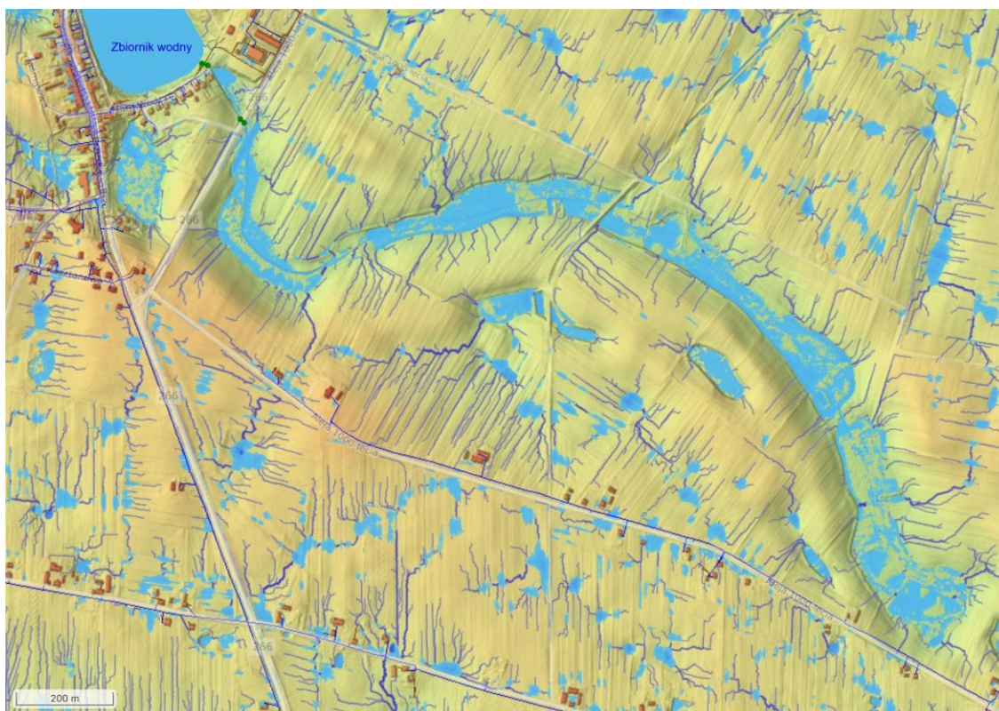
Ryc. 6.4.1.6. Zasięg oddziaływania spiętrzenia wód do 86,00 m n.p.m. – stałe zawilgocenie doliny cieku powyżej zbiornika (niebieski kolor na mapie) m. in. działki nr 526/3, 533/1, 523/3, 534/1, 5/3, 536/5, 542/1, 543/1, 541, 544/1 obręb Służewo.
