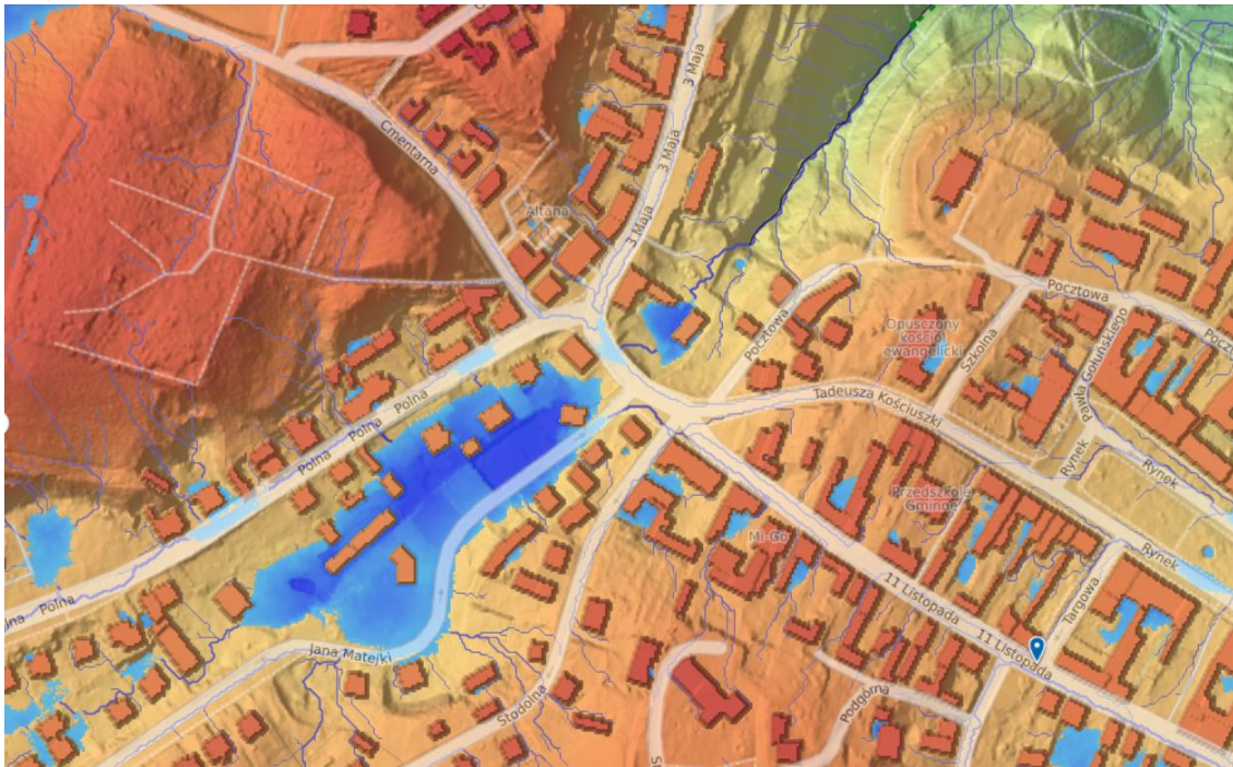
Ryc. 6.4.1.2. Numeryczny model terenu wraz z zasięgiem podtopień w sytuacji przy opadzie 20 mm
