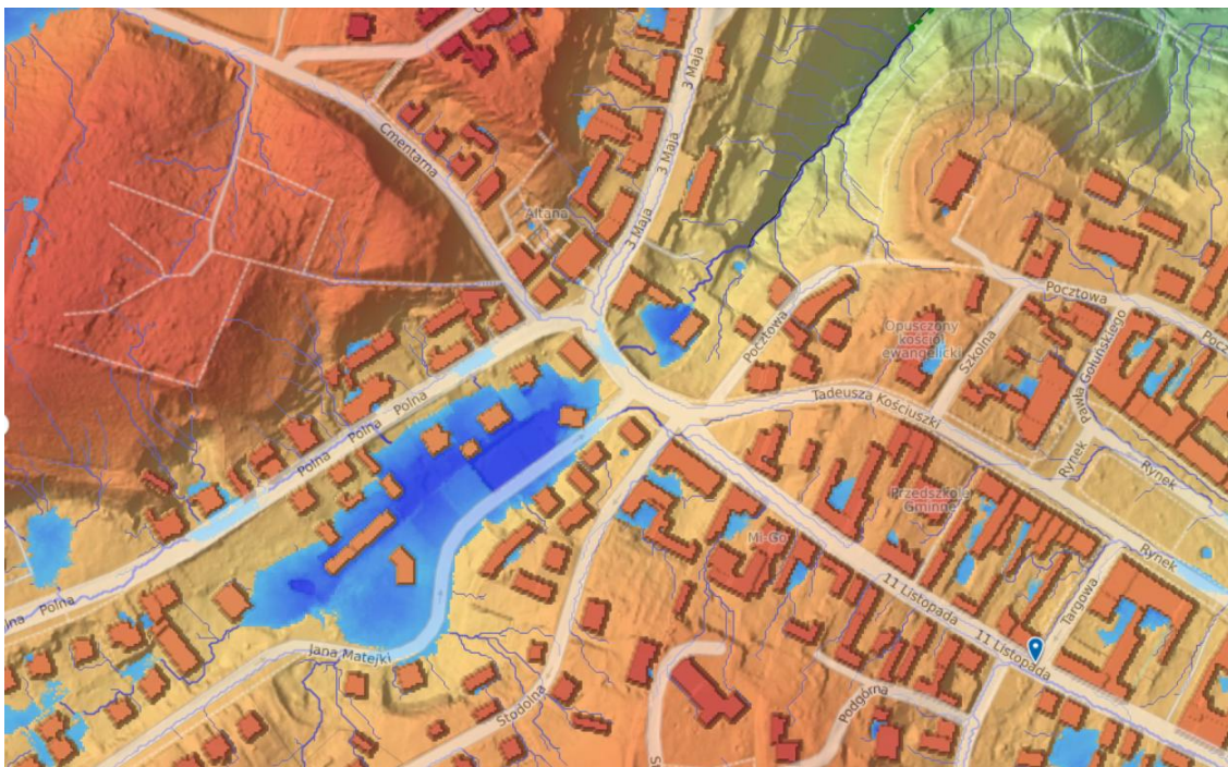
Ryc. 6.4.1.2. Numeryczny model terenu wraz z zasięgiem podtopień w sytuacji przy opadzie 20 mm
