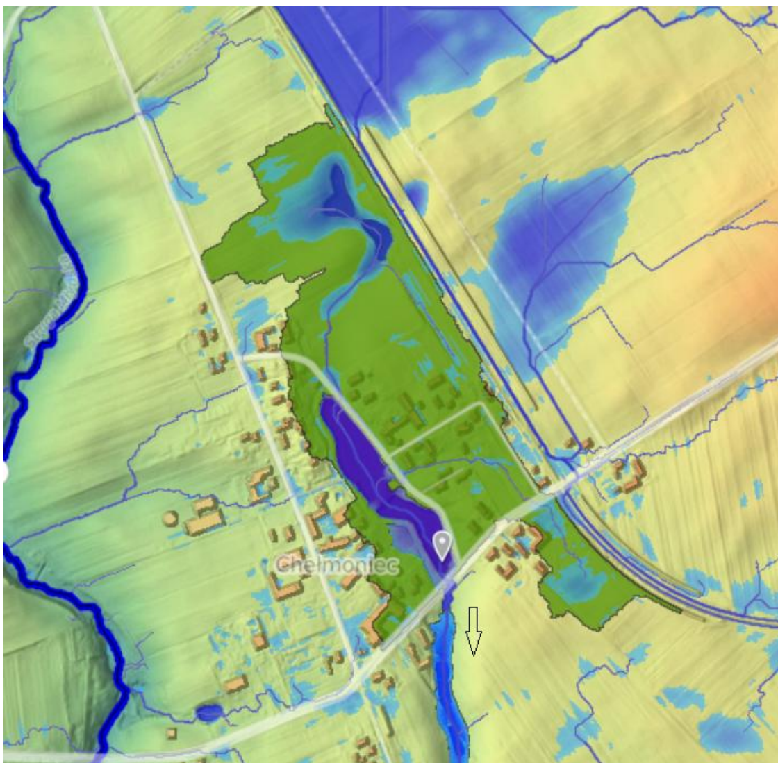
Ryc. 6.4.2.4. Obniżenie w którym znajdują się Zbiorniki zasilane jest wodami ze zlewni o powierzchni 0,17 km 2 (17 ha)
