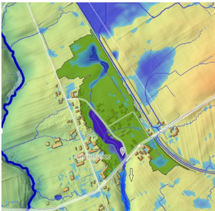
Ryc. 6.4.2.4. Obniżenie, w którym znajdują się zbiorniki zasilane jest wodami ze zlewni o pow. 0,17 km 2 (17 ha)
