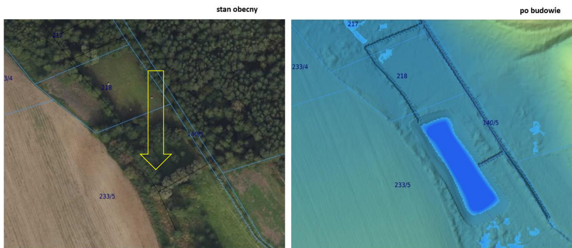
Ryc. 6.4.1.8. Lokalizacja projektowanego zbiornika w miejscu istniejącego naturalnego obniżenia terenu na działce 233/5. Istniejące rowy melioracyjne mogą być wykorzystane jako doprowadzalnik i odprowadzalnik wód do zbiornika.
