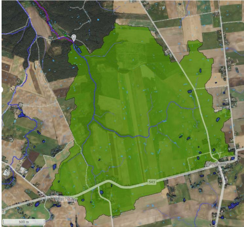
Ryc. 6.4.1.5. Zlewnia ciek do profilu połączenia ze Zbiornikiem nr 1 i 2. Powierzchnia drenażu wód to 3,46 km 2 .
