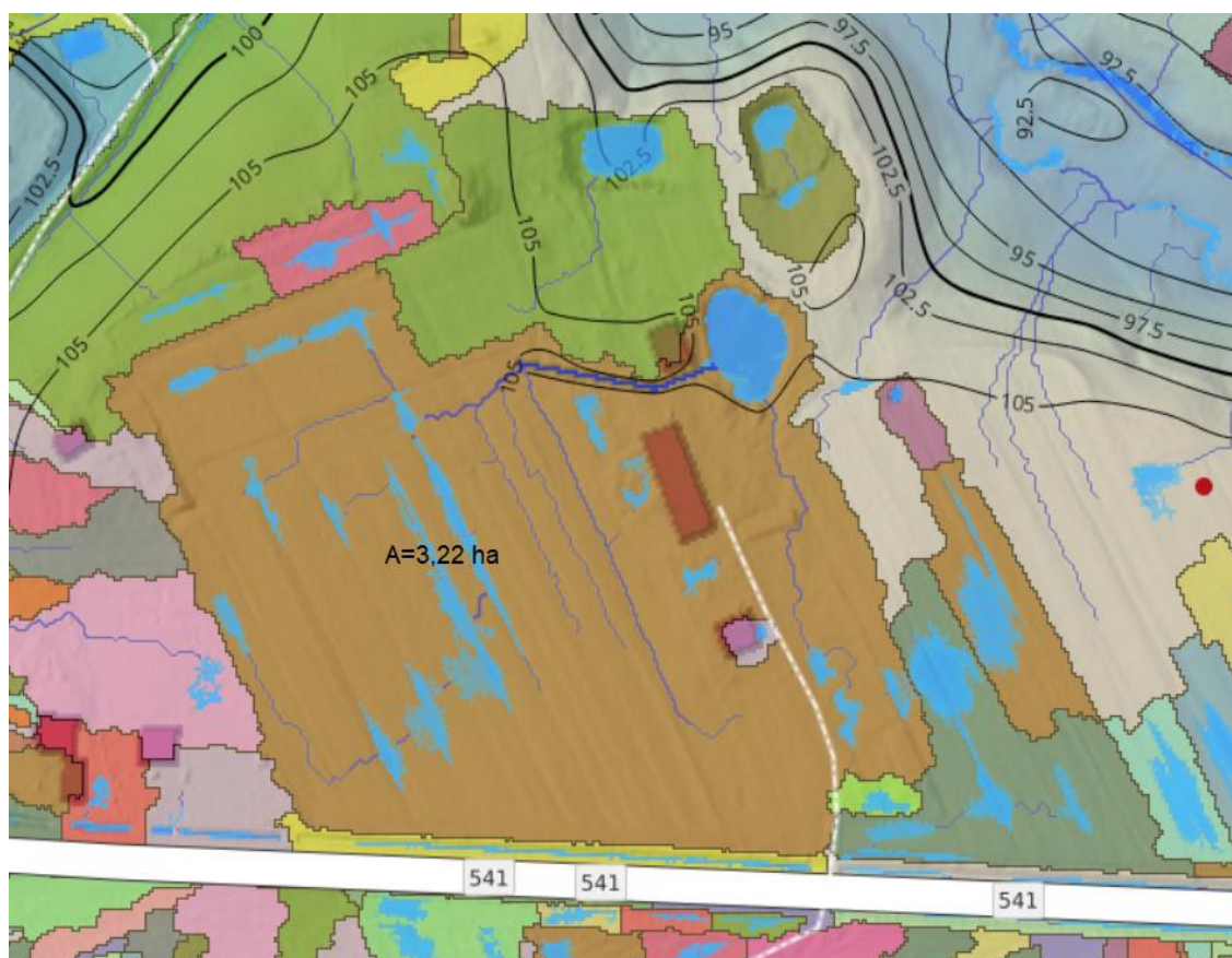
Ryc. 6.4.1.10. Zlewnie cząstkowe w otoczeniu zbiornika po zrealizowaniu prac - budowa rowu doprowadzającego część wód z sąsiedniej zlewni.
