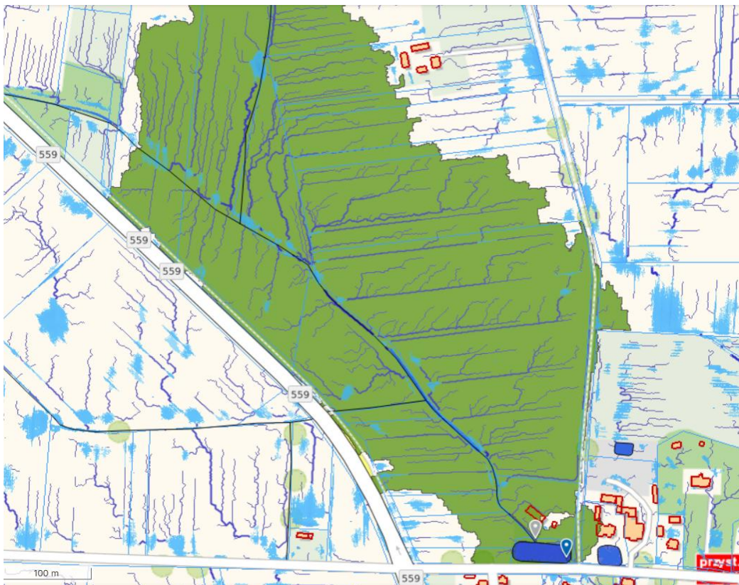
Ryc. 6.4.1.2. Zlewnia całkowita o powierzchni 0,23 km 2 odprowadzająca wody opadowe do zbiornika na działce nr 53 w m. Jasień.
