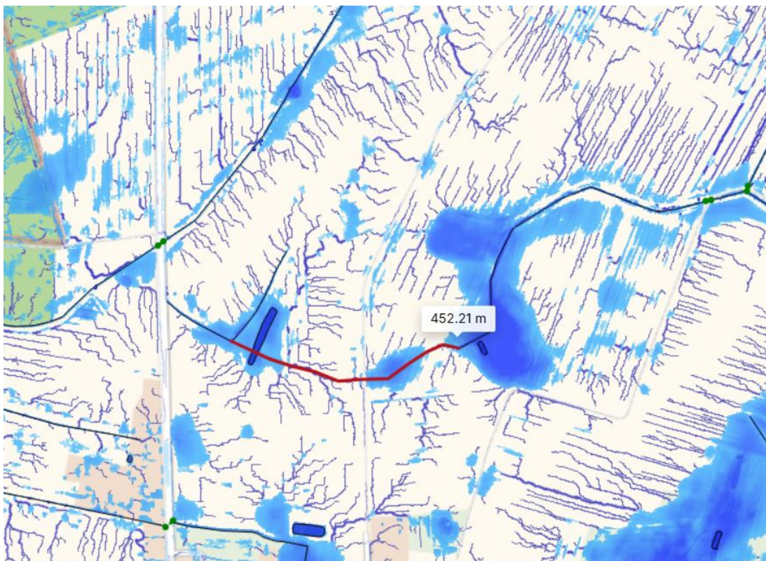
Ryc. 6.4.1.3. Szczegółowy przebieg połączenia dwóch odcinków rowów melioracyjnych zwykłych – działki 247/4 i 100/27, obręb Wójcin.
