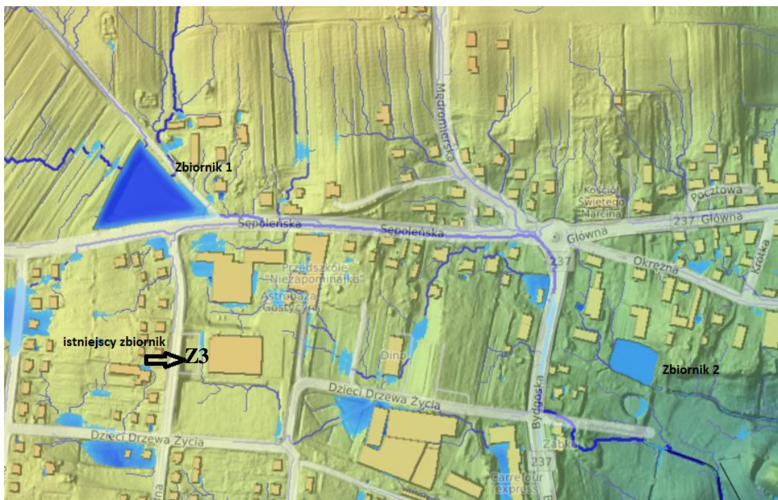
Ryc. 6.4.2.7. Projektowane dwa zbiorniki oraz istniejący zbiorniki o łącznej pojemności retencjonowania wody około 3300 m 3 (Z1- 2100 m 3 ; Z2 900 m 3 ; Z3-300 m 3 ).
