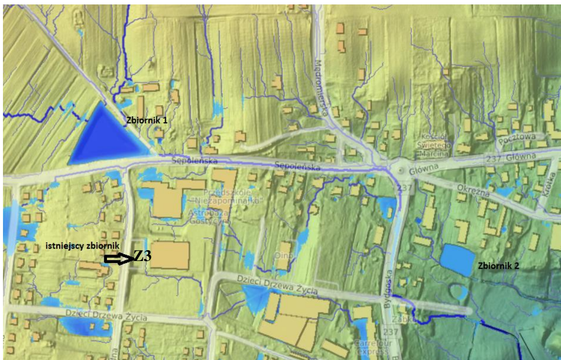
Ryc. 6.4.2.7. Projektowane dwa zbiorniki oraz istniejący zbiorniki o łącznej pojemności retencjonowania wody ok. 3300 m 3 (Z1- 2100 m 3 ; Z2 900 m 3 ; Z3-300 m 3 ).
