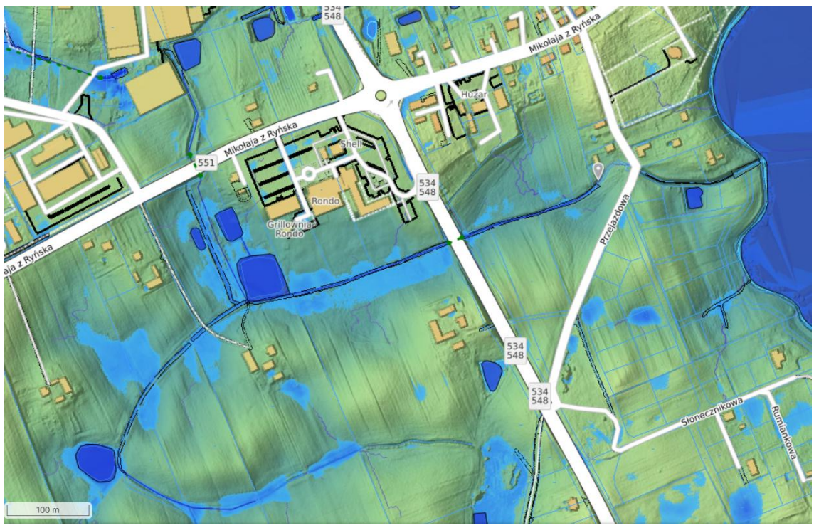
Ryc. 6.4.1.2. Zasięg podtopień otoczenia rowu Wh po zachodniej stronie Jeziora w trakcie opadu 20 mm.
